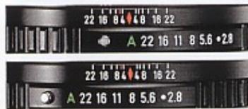
**Programm-wähler.** Mit der Programm-wahl-taste und den Tipp-tasten geben Sie die gewünschte Belichtungsart ein. Programm-Automatik, Blenden-Automatik und Zeit-Automatik I sind dann möglich, wenn der Blendenring des Objektivs auf «A» steht. Zeit-Automatik II, Nachführmessung, Blitzsynchronisation und Langzeitaufnahmen können gemacht werden, wenn der Blendenring von Hand eingestellt wird.
